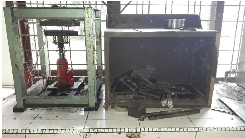
Gambar 4. Alat cetak tekan panas manual dan cetakan papan partikel di Laboratorium Kimia Polimer FMIPA USU Medan.
