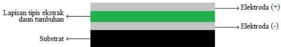
Gambar 1 : Skema lapisan tipis ekstrak daun tumbuhan yang diapit oleh dua buah elektroda.
